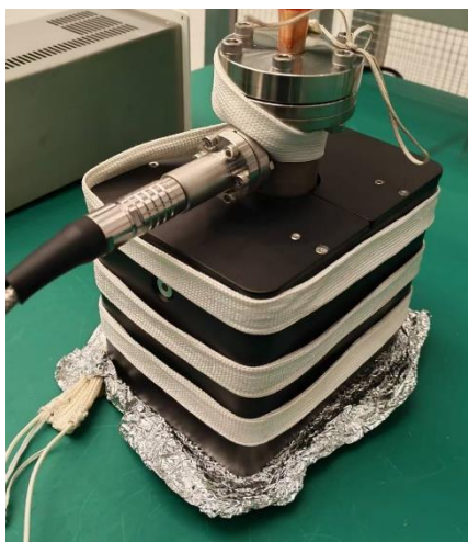
图5 加热带包裹方式
