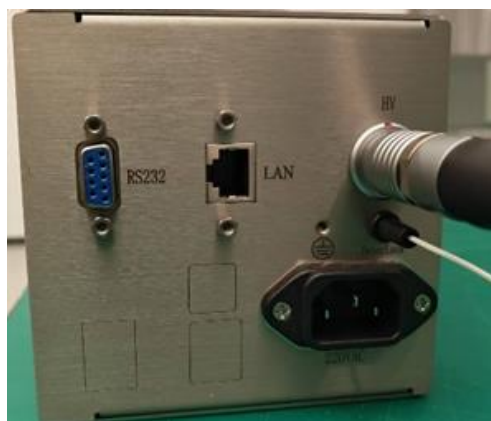
图2 高压电缆与控制器连接
