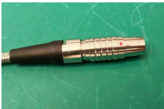
图3 离子泵连接端高压电缆
