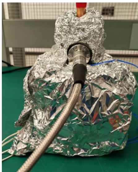
图7 离子泵铝箔包裹方式
