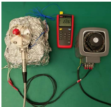
图8 离子泵与加热设备的连接
