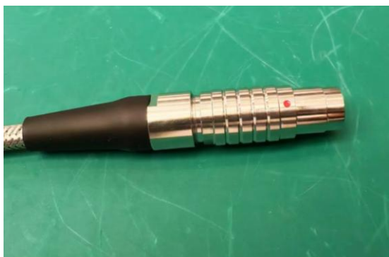
图3 离子泵连接端高压电缆
