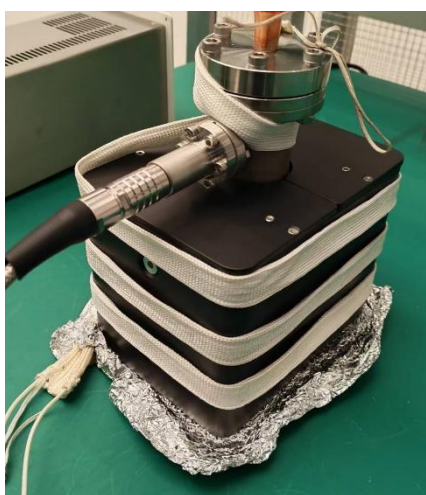
图5 加热带包裹方式
