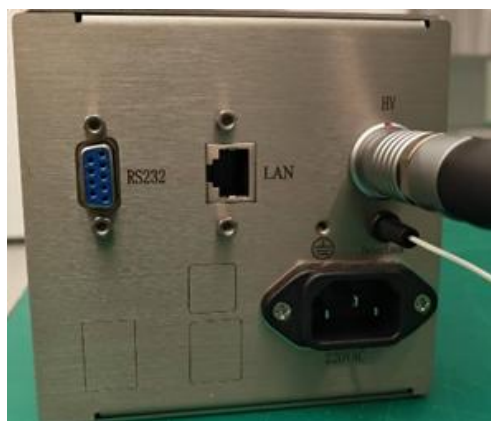
图2 高压电缆与控制器连接
