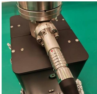
图4 高压电缆与离子泵连接
