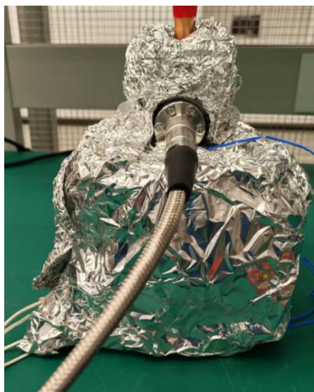
图7 离子泵铝箔包裹方式
